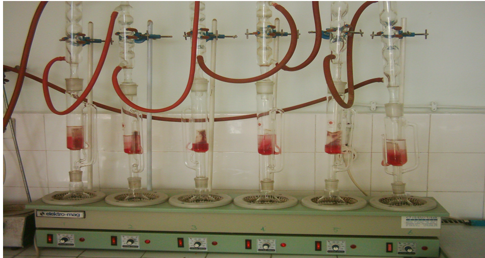
Şekil 14: Hypericum perforatum L Bitkisinde Methanol ile Ekstraksiyon
