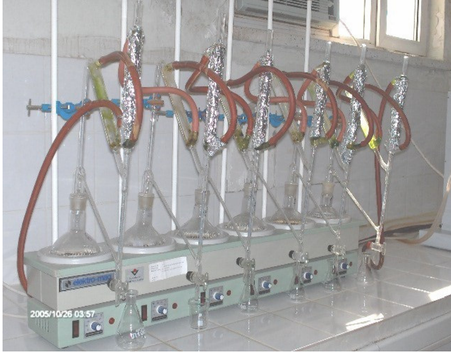
Şekil 13: Uçucu Yağ Analizinde Kullanılan Neo-Clevenger Aparenti
