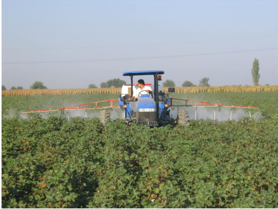
Şekil 5. Çatısı yükseltilmiş traktörle defolyant atılması
