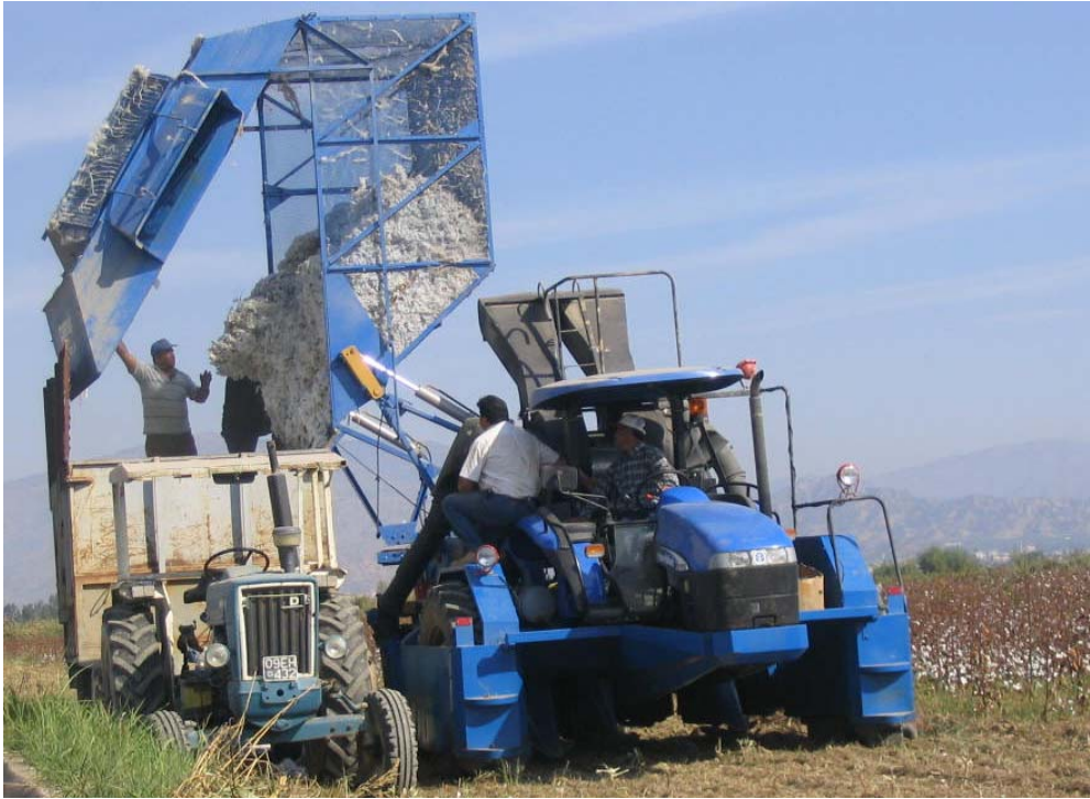
Şekil 10. Pamuk hasat makinası deposunun boşaltılması
