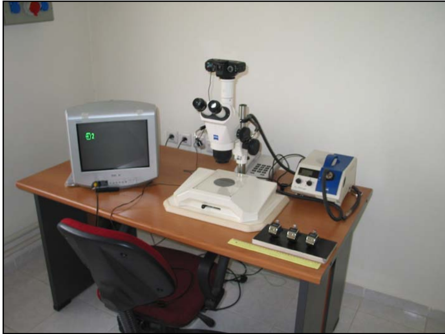
Şekil 7. Stereolojik analizlerin yapıldığı düzenek
