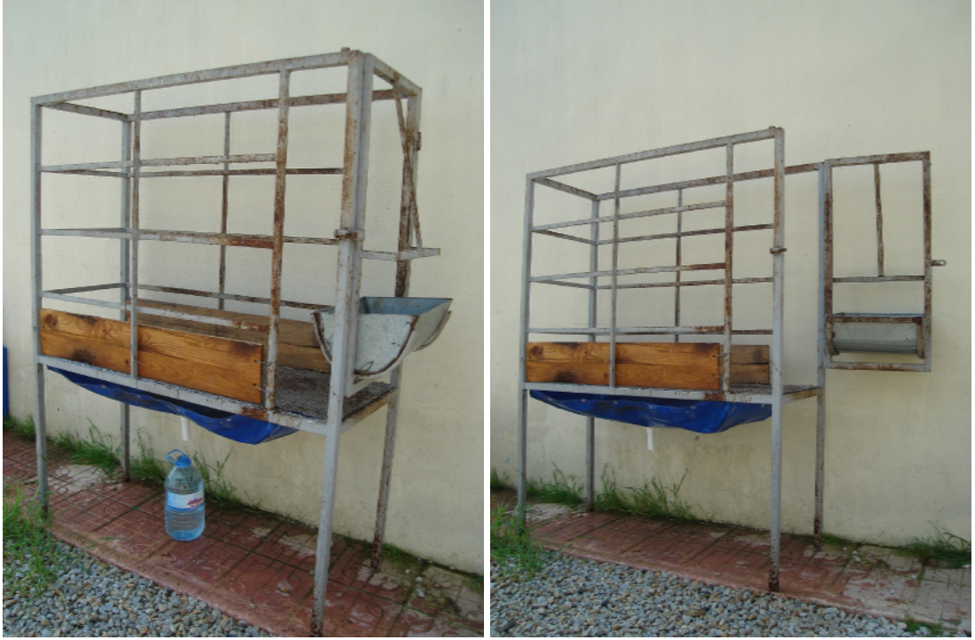
Şekil 4. Denemede kullanılan metabolik kafesler
