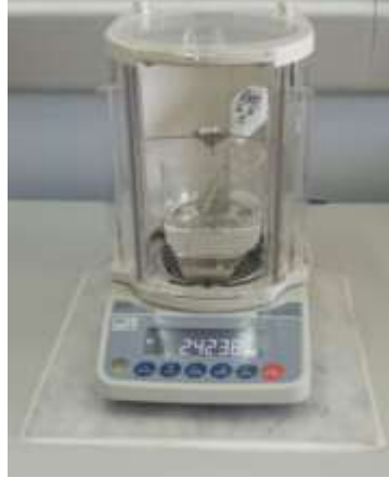
Şekil 3.5. Yoğunluk ölçümlerinde kullanılan hassas terazi ve yoğunluk belirleme kiti.
