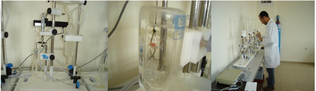
Resim 7. Damar halkalarının izole organ banyosu düzeneğine asılması ve kimyasal uygulamaları.
