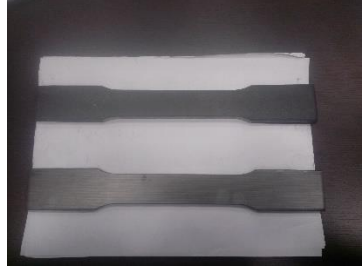
Şekil 3.2. Sıvama öncesi - hadde yönünde ve sıvama sonrası - sıvama yönüne dik alınan numuneler
