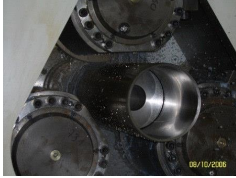
Şekil 1.29. Geriye doğru bağımsız-et kalınlığı deęişimli sıvama ile işlenmekte olan bir parça.
