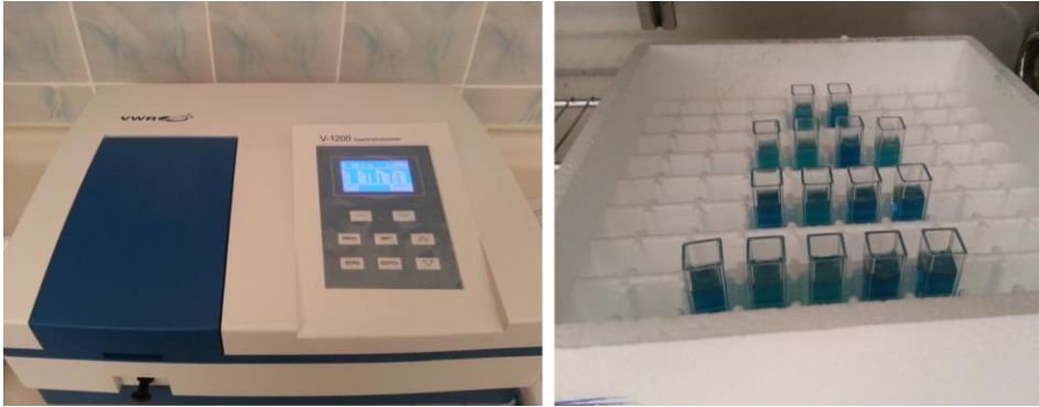
Şekil 3.8. Spektrofotometre cihazı ile sütlerin toplam fenolik madde içeriklerinin belirlenmesi
