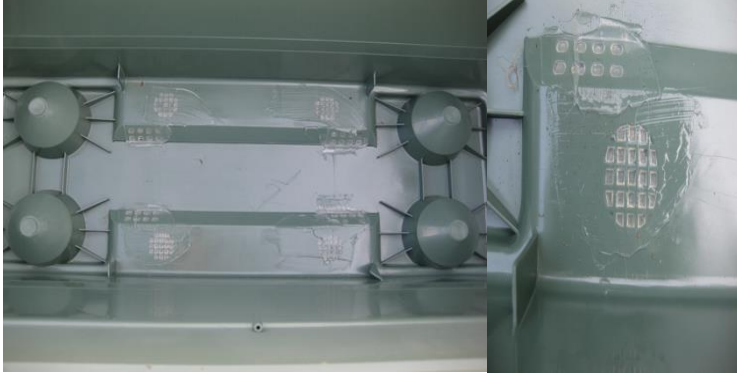
Şekil 3.2. Su Drenajının Engellenmesi İçin Saksı Drenaj Deliklerine Uygulanan Silikon
