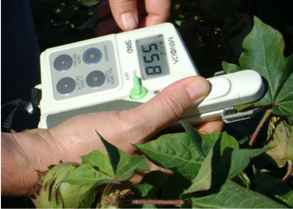
Şekil 3.3. Klorofil İçeriği (Minolta SPAD 502 aleti)
