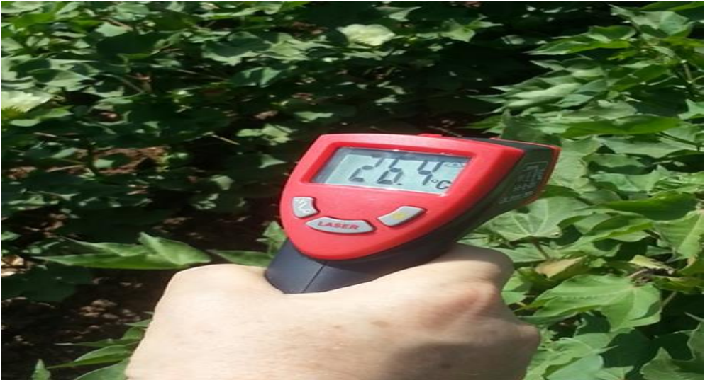
Şekil 3.2. Kanopi Sıcaklığı (2956 IR-Infrared Thermometer)
