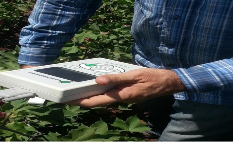
Şekil 3.1. Stoma İletkenliği Ölçümü (SC-1 Leaf Porometer, Degacon)
