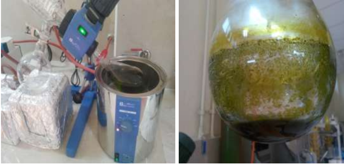
Resim 2: Evaporasyon( Döner buharlaştırıcı) cihazı ve elde edilen özüt.
