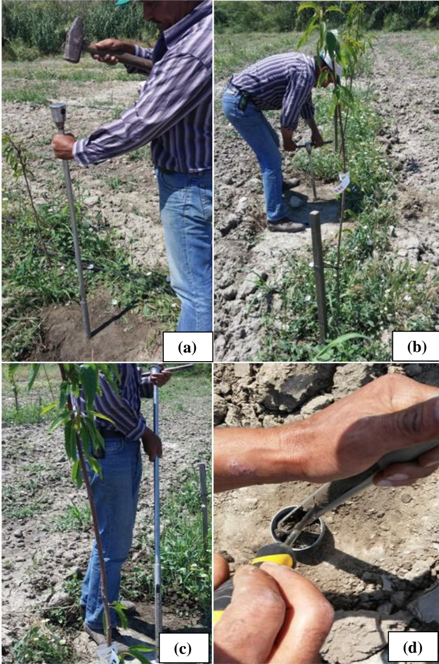
Şekil 3.10. Gravimetrik yöntem aşamaları (a):sondanın çekiçle toprağa çakılması,(b):Çakılan sondanın topraktan çıkarılması, (c): Sondaya dolan toprak örneği, (d): Sondaya dolan toprak örneğinin çelik kapaklı kaplara doldurulması
