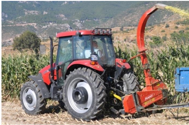
Şekil 3.5. Tek Sıralı Disk Kıyıcı Silajlık Mısır Hasat Makinasının Çalışması
