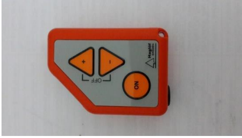
Şekil 3.11. Elektronik ağaç boyu ölçer
