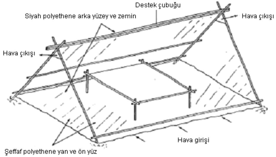
Şekil 1.4 Çadır tipi bir kurutucu
