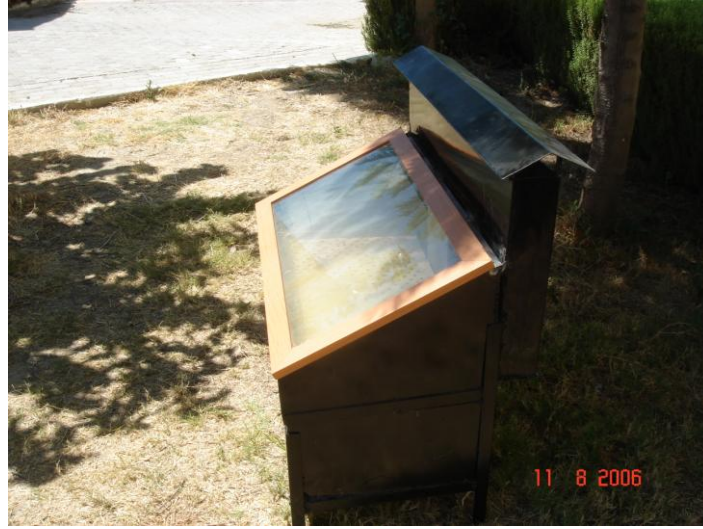
Şekil 3.5 Doğal akımlı model kurutucunun yandan görünüşü
