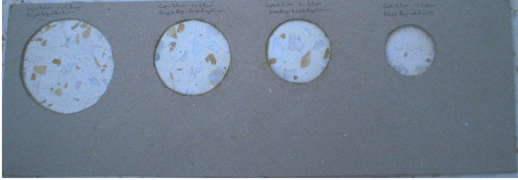
Şekil 3.2. Meyveleri farklı büyüklükte boylara ayırmada kullanılan halkalar
