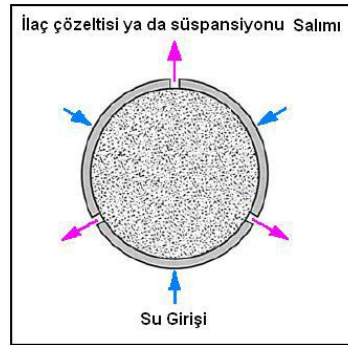
Şekil 1.6. Ozmotik kontrollü ilaç salım sisteminin şematik görünümü (Kışmir, 2011).
