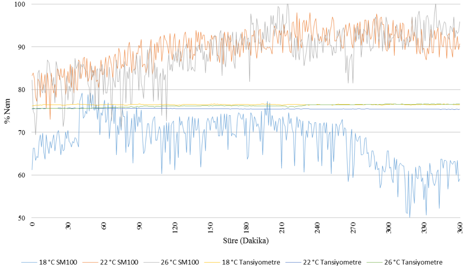
Şekil 4.28. %80 nem değerindeki denemelerde SM100 ve tansiyometre nem eğrisi
