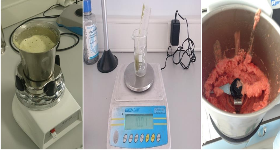
Şekil 3.12. Örneklerin parçalanması ve falkon tüpler içine tartılması
