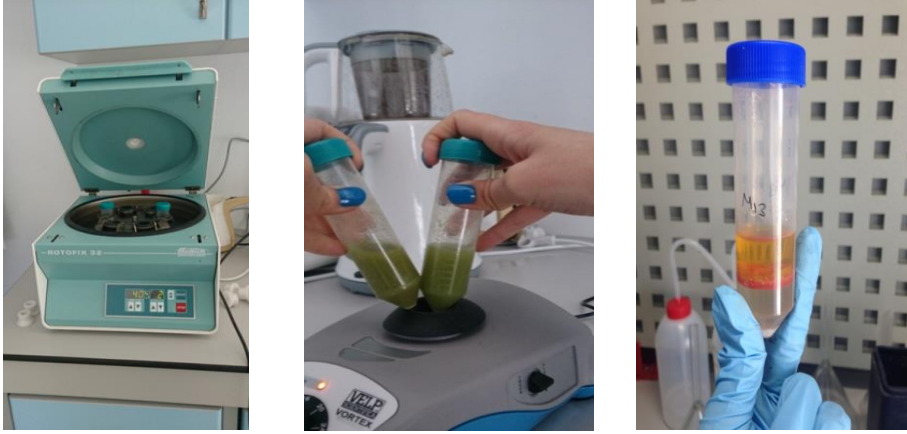
Şekil 3.13. Vorteksleme, santrifüj ve karışımı oluşturan bileşiklerin ayrılması
