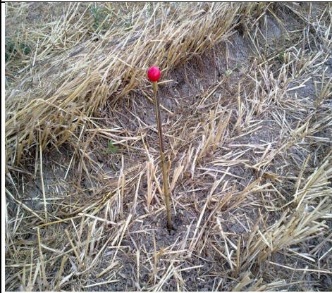
Sırtlarda toprak sıcaklığı ölçülmesi
