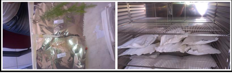
Şekil 3.13. Taze ağırlıkları alınan bitki parçalarının paketlenerek etüvde 105 °C’de (ağırlık sabitlenene kadar) kurutmaya bırakılması
