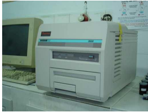
Şekil 3.1. Işınma ölçümlerinin yapıldığı TLD okuyucu sistemi (Harshaw TLD 3500).
