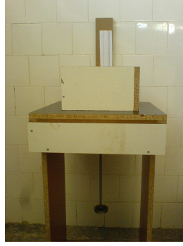
Şekil 3.1. Doğal yığılma açısı ölçüm düzeneği
