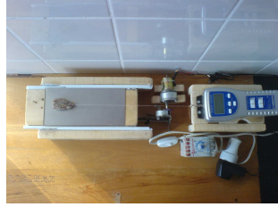
Şekil 3.3. Sürtünme direnci ölçüm düzeneği
