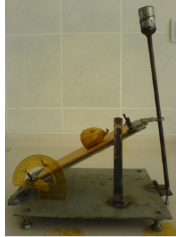
Şekil 3.2. Yuvarlanma direnci ölçüm düzeneği
