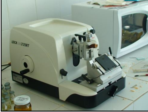
Şekil 3.5. Kesit alınımında kullanılan rotary mikrotom
