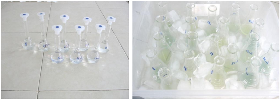
Şekil 3.5. Örneklerin balon jöjelere hazırlanması ve buz banyosu içerisinde antron çözeltisi eklenmesi
