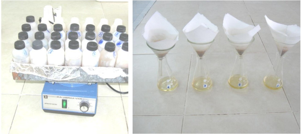
Şekil 3.4. Örneklerin çalkalanması ve süzülmesi
