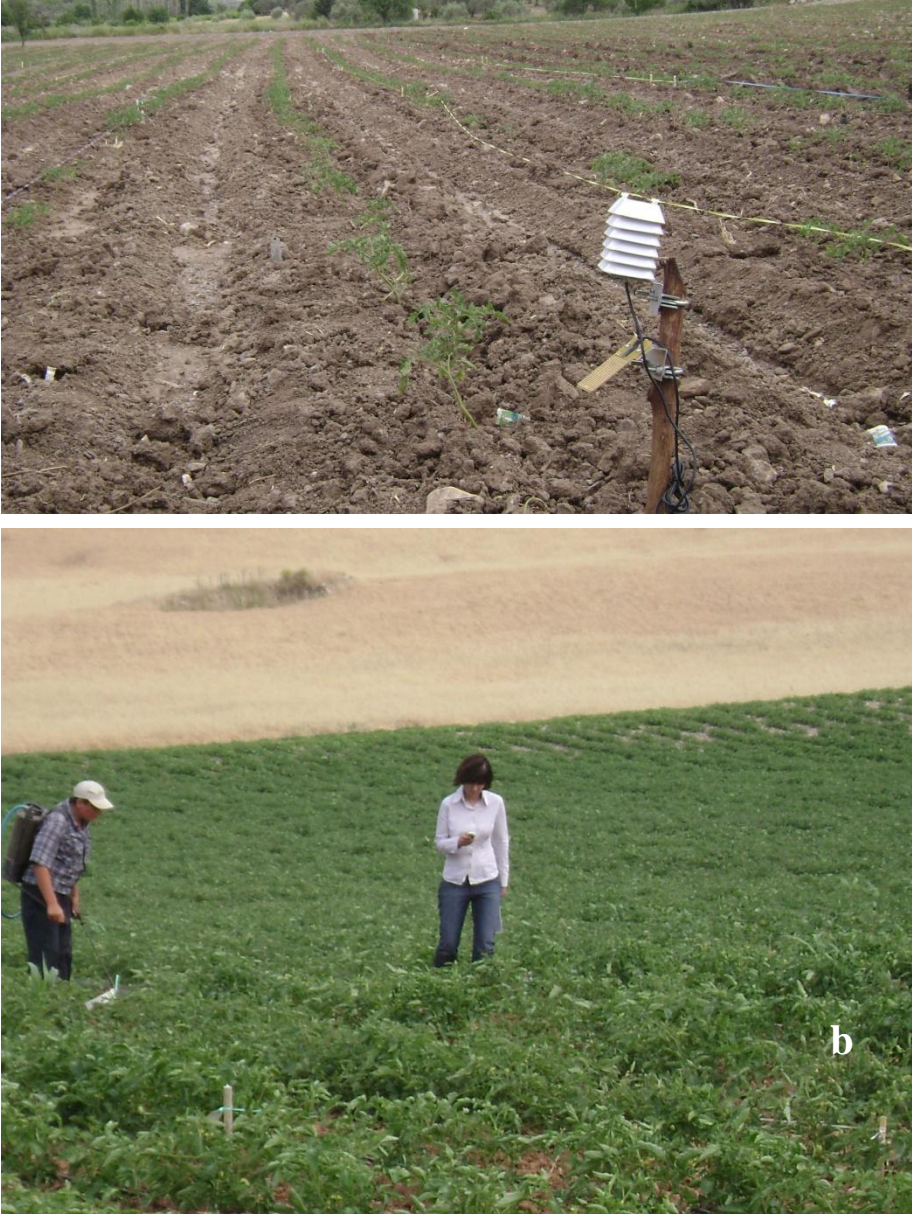
Şekil 3.2. 2009 ve 2010 yıllarında Belen köyü (Saruhanlı /Manisa)'nde tahmin ve uyarı çalışmaları için deneme alanına yerleştirilen veri kaydedici (a), deneme parsellerindeki ilaçlama çalışmaları (b)
