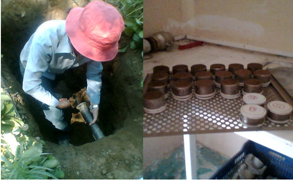
Şekil 3.2.Bozulmamış toprak örneklerinin alınması
