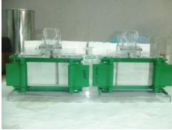
Resim 2. Jelin döküleceği elektroforez camlarının düzenek üzerine yerleştirilmesi.
