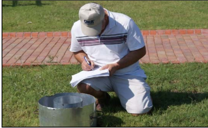
Şekil 3.13. Çift silindir infiltrometre ile infiltrasyon testi
