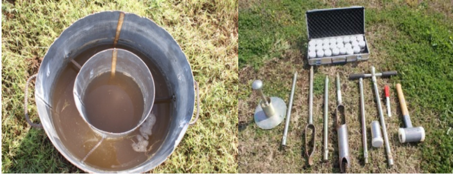
Şekil 3.5 Çift silindirli infiltrometre ve bozulmamış numune alma araçları
