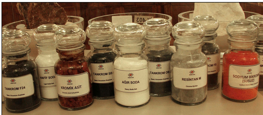
Şekil 12: Cam üretiminde kullanılan bazı kimyasallar (Kaynak: ‘Kum Ateş ve Cam: Şişecam...’ 1935’ten Günümüze Camla Yazılan Tarih, İstanbul Sergisi’nden fotoğraflanmıştır, 01 Şubat 2012.)
