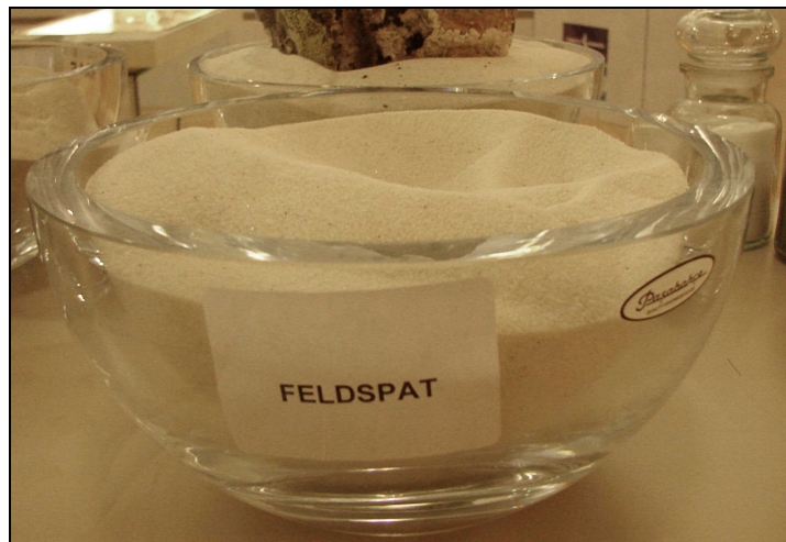
Şekil 10: Cam sanayinde kullanılan hammadde feldspat (Kaynak: 'Kum Ateş ve Cam: Şişecam...' 1935'ten Günümüze Camla Yazılan Tarih, İstanbul Sergisi'nden fotoğraflanmıştır, 01 Şubat 2012.)
