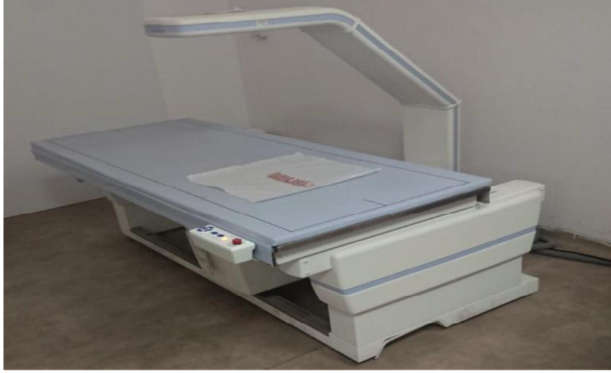
Resim 3.5. Deneklerden birine ait lomber vertebral kolon (LV2-LV5) spesmeninin DEXA cihazına (Hologic QDR-4500A, Hologic Inc., Waltham, MA, USA) yerleştirilmesi ve BMD ölçülmesi işlemi görülmektedir
