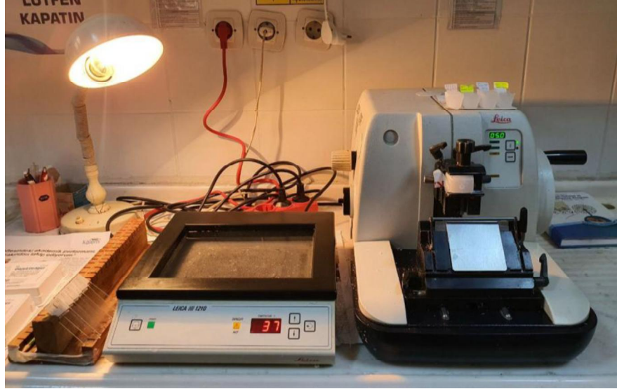
Resim 3.8. Işık mikroskopik incelemeler yapılmak üzere 5 µm kalınlığında kesitlerin hazırlanmasında kullanılan mikrotom (Leica RM 2145) ve sıcak su banyosu düzeneği görülmektedir
