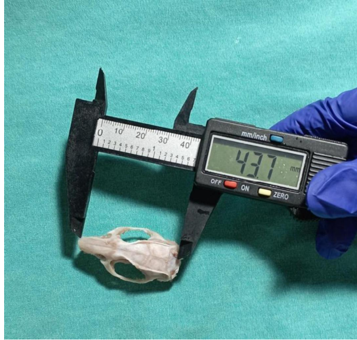
Resim 3.7. Her bir deneğe ait kranium spesmenleri üzerinde, yanılma payı \pm 0.02 mm olan bir kumpas (vernier caliper) kullanılarak gerçekleştirilmiş olan bir ölçüm örneği görülmektedir
