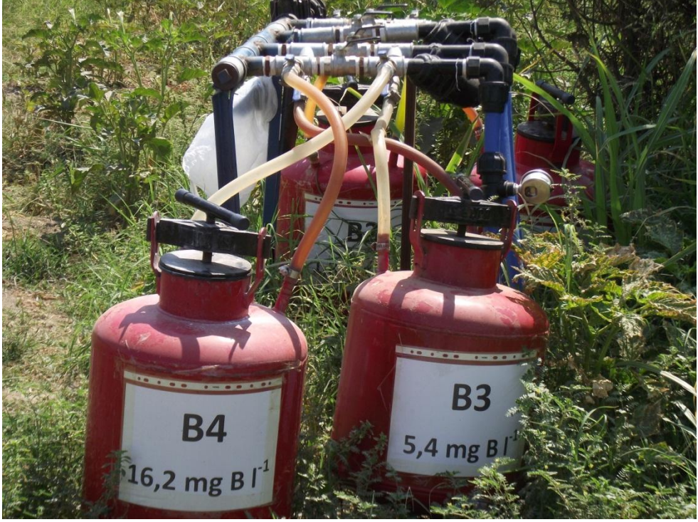
Şekil 3.5. Denemede kullanılan ana kollektör ve gübre tankları
