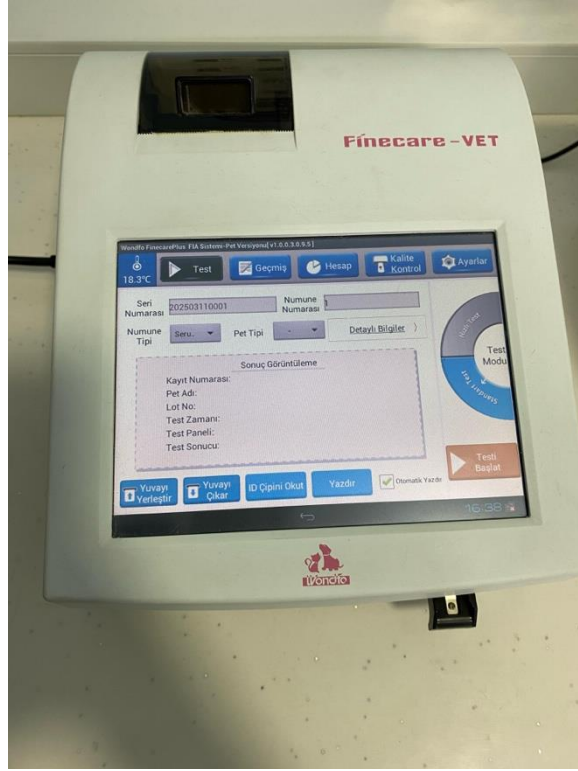
Resim 5. T4 analizlerinin yapıldığı Fineware-Vet Wondfo Immunoassay analiz cihazı (Çin) (tez arşivine ait).
