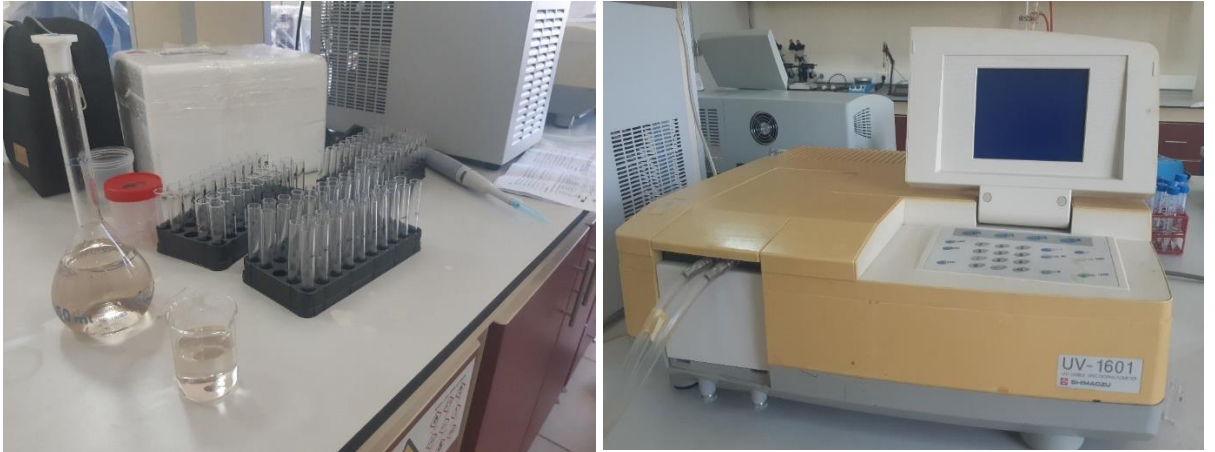
Şekil 4. Seruloplazmin (Cp) konsantrasyonunun spektrofotometrik olarak belirlenmesi
