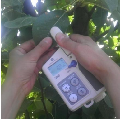
Şekil 3.2.7.1. Yapraklarda klorofil değerinin SPAD metre ile ölçümü
