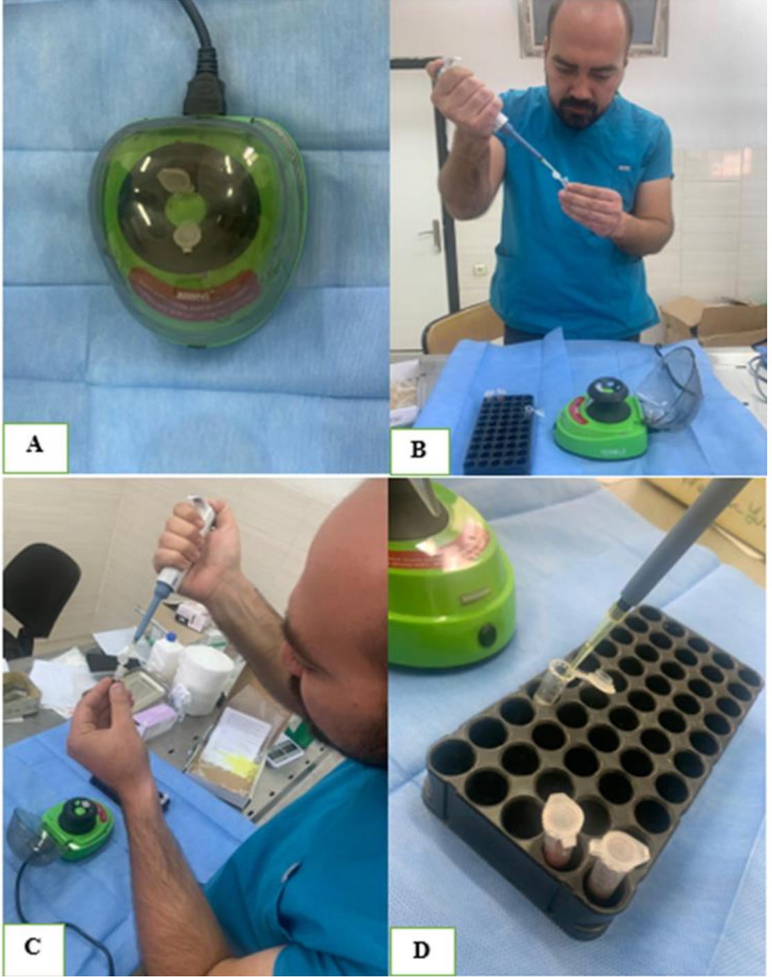
Resim 18. (A) Kan örneğinin 1000 devir/dakika'da santrifüj edilmesi, (B, C, D) santrifüj sonrası elde edilen serumun yeni bir ependorf tüpüne otomatik pipet ile alınması
