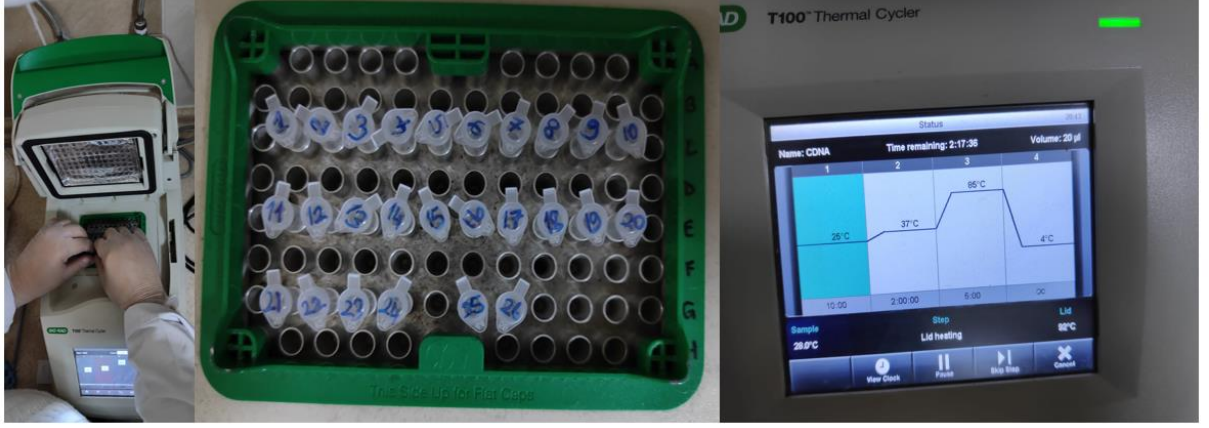
Resim 20. Eppendorf tüplerin inkübatöre yerleştirilip cDNA eldesi için inkübe edilmesi.
