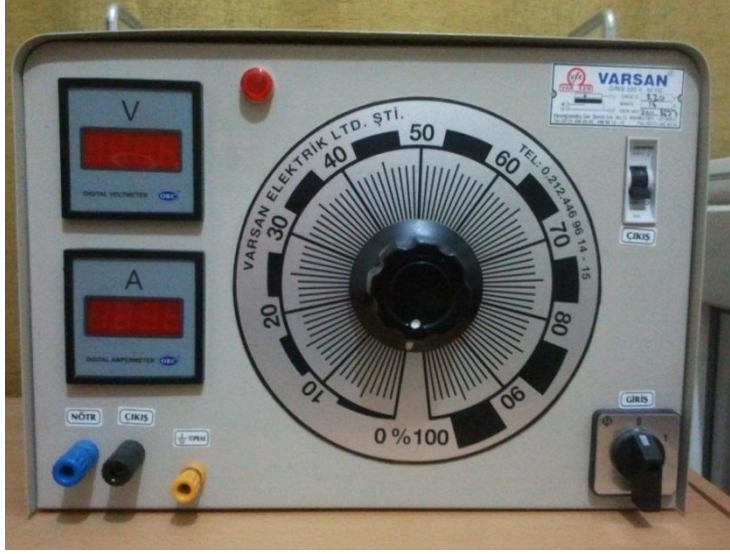
Şekil 3.6. Ayarlı transformatörün genel görünüşü
