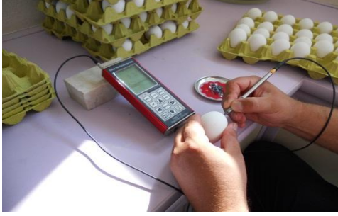
Şekil 3.4. Yumurtanın kabuk kalınlığının ölçülmesi
