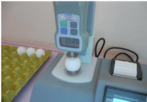
Şekil 3.3. Yumurtanın kabuk mukavemetinin ölçülmesi
