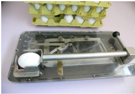
Şekil 3.2. Yumurtanın şekil indeksinin ölçülmesi
