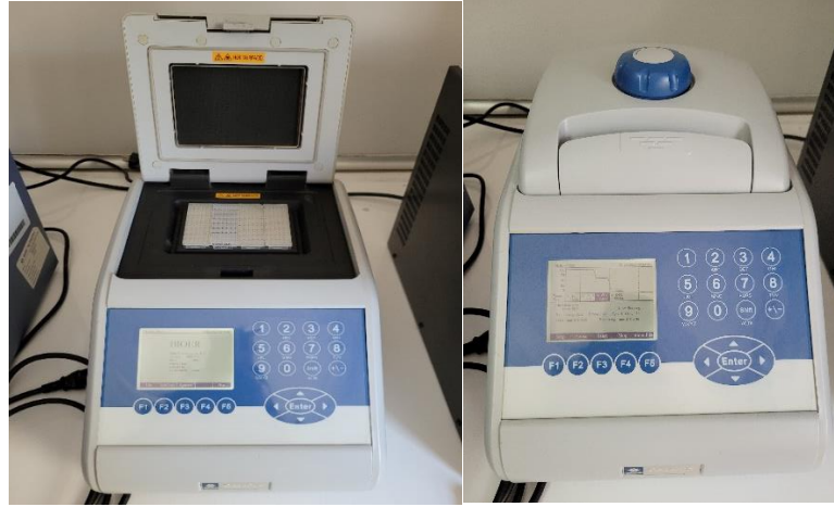
Resim 8. Piko plateler BIOER Gene-Pro Thermal Cycle cihazına yerleştirilmiş.
