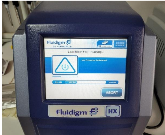
Resim 11. Fluidigm IFC Controller'de Flex-Six Chip'in mix ve assayların reaksiyon kanallarına yüklenmesi.
