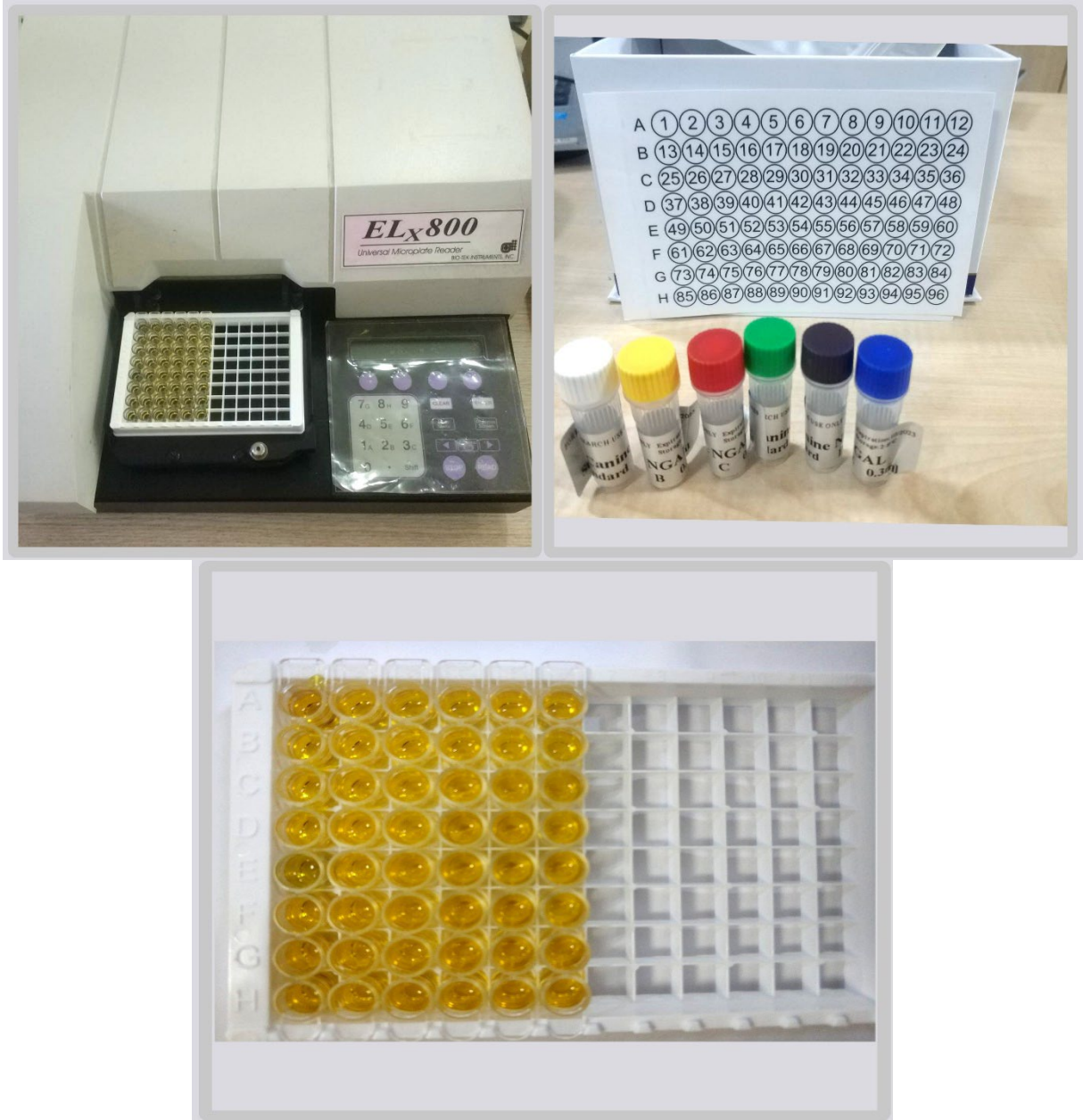
Resim 8: ELx800 (BIO-TEK Instruments, Inc./USA brand ELISA) cihazı, NGAL ölçüm solüsyonları ve NGAL ölçümü
