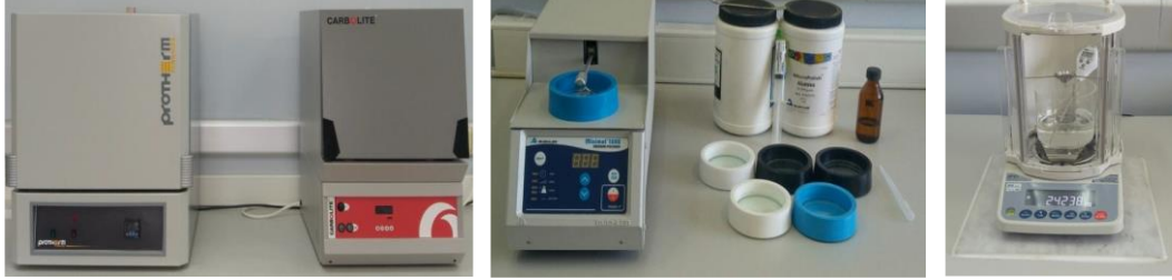
Resim 3.2. Eritme ve tavlama için kullanılan fırınlar, zımparalama- parlatma cihazı ve ekipmanları, hassas terazi ve yoğunluk belirleme kiti.
