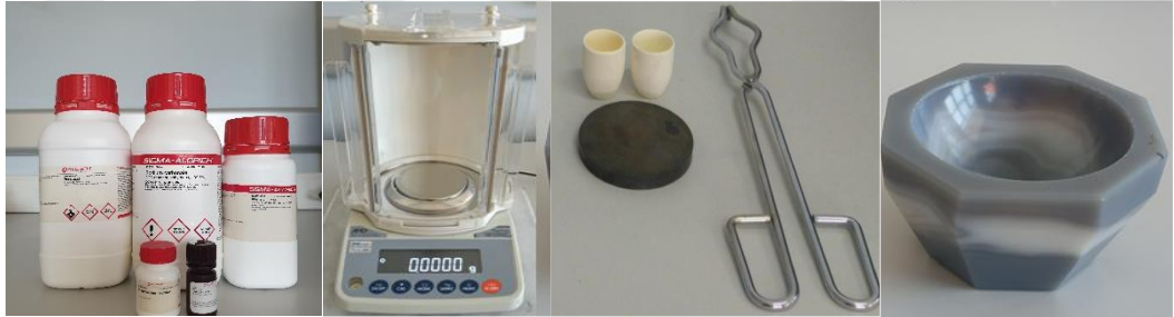
Resim 3.1. Oksit tozlar, hassas terazi, sentezde kullanılan paslanmaz çelik kalıp, alümina kroze, maşa ve agat havan.
