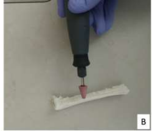
Resim 6. 3 boyutlu baskı sonrası destek elemanların temizlenmesi. A: parçaların uzaklaştırılması. B: Gravür ile yüzey temizliği.
