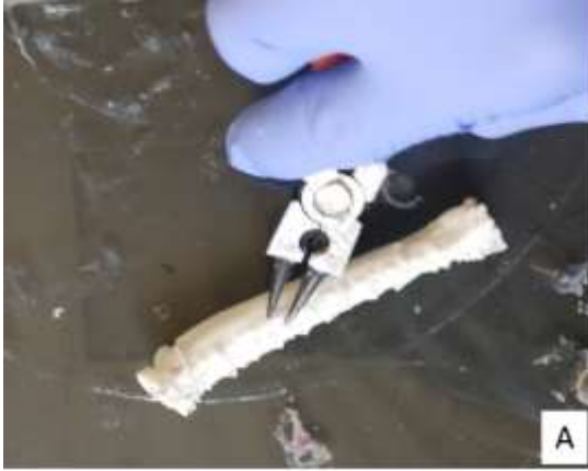
Resim 6. 3 boyutlu baskı sonrası destek elemanların temizlenmesi. A: parçaların uzaklaştırılması. B: Gravür ile yüzey temizliği.
