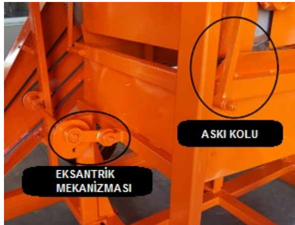
Resim 3.8. Elek ünitesi eksantrik mekanizması ve askı kolları
