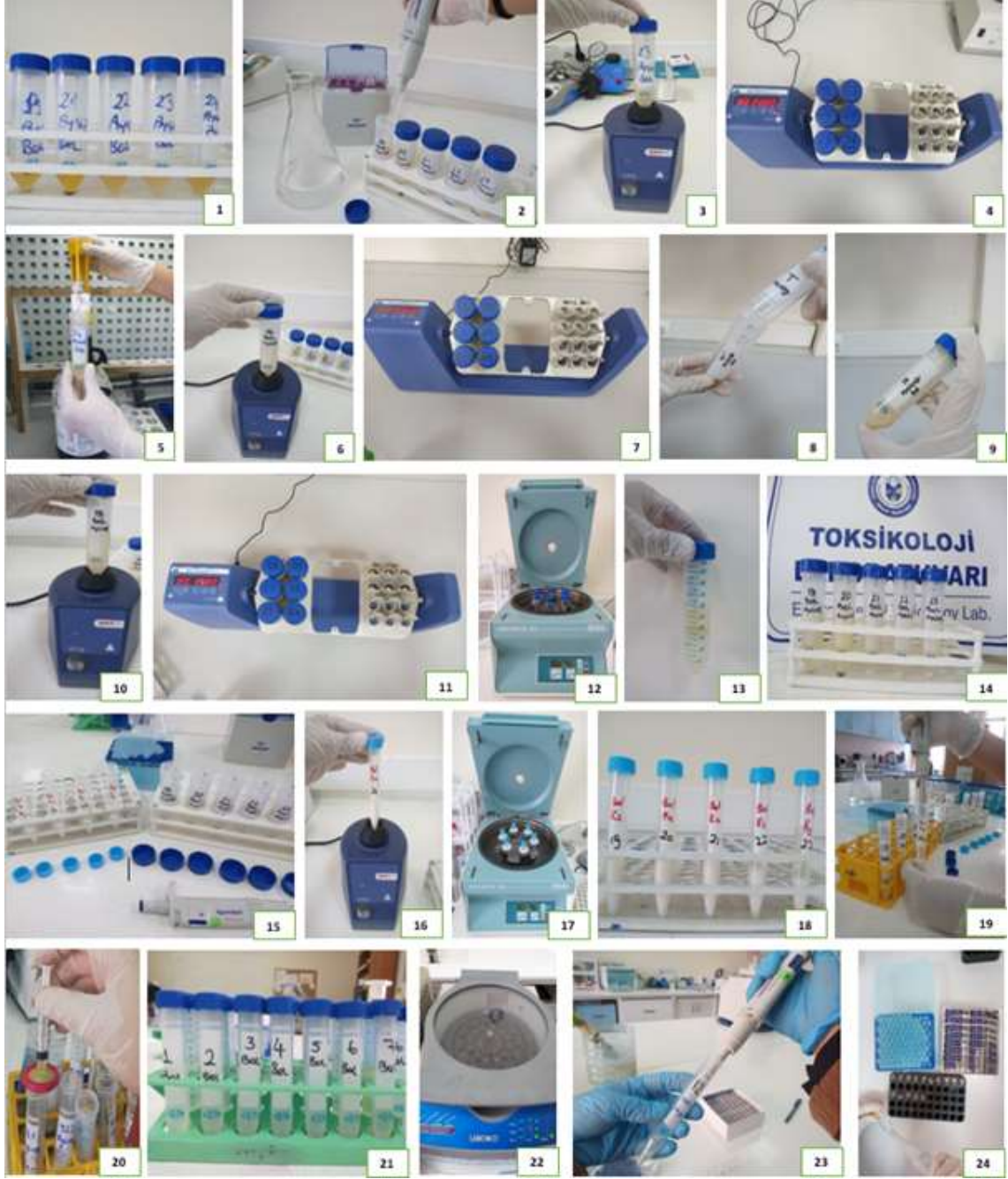
Şekil 3.13. Bal örneklerinin ekstraksiyon işlemi.
