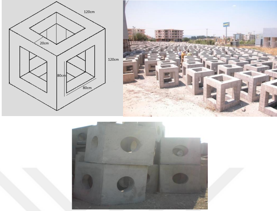
Şekil 3.2. Yapay resif bloğu ve imal edilmiş yapay resif blokları (Savut, 2013)
