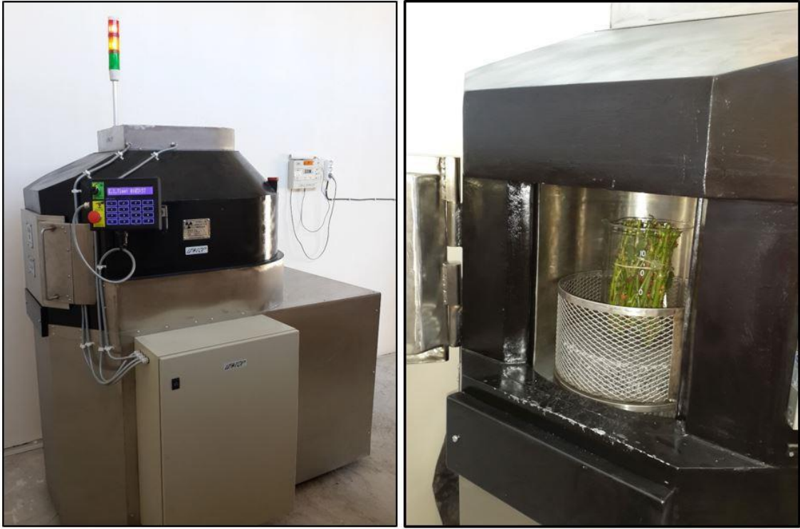
Resim 3.2. Türkiye Atom Enerjisi, Sarayköy Nükleer Araştırma ve Eğitim Merkezinde bulunan İzotop, Ob-servo Sanguis B/01 model 3600 dörner tablalı, klimatize Gama (60Co) kaynağı.
