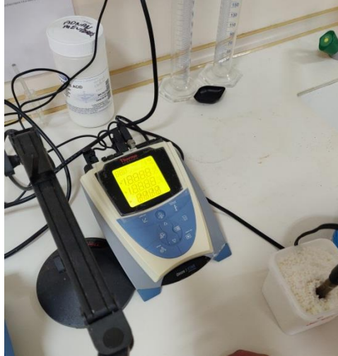
Resim 5. Peynirlerde birleşik elektrotlu pH metre (Orion 3 Star) ile yapılan ölçüm
