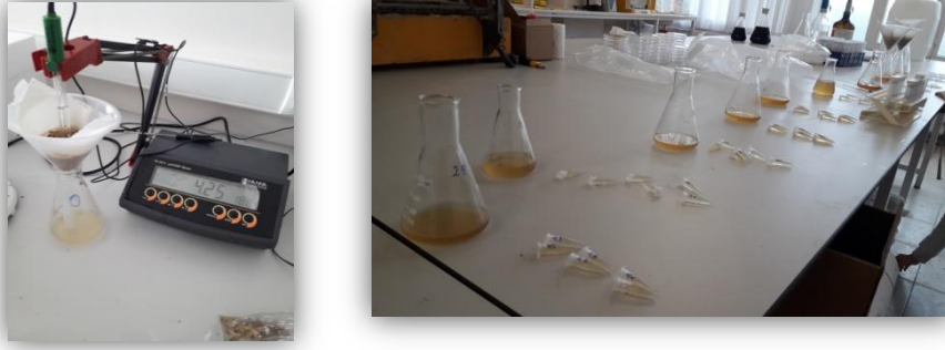
Resim 3.6. Süzüntüden geçirilen silaj suyunun pH değerinin ölçümü ve silaj suyu numune alımı
