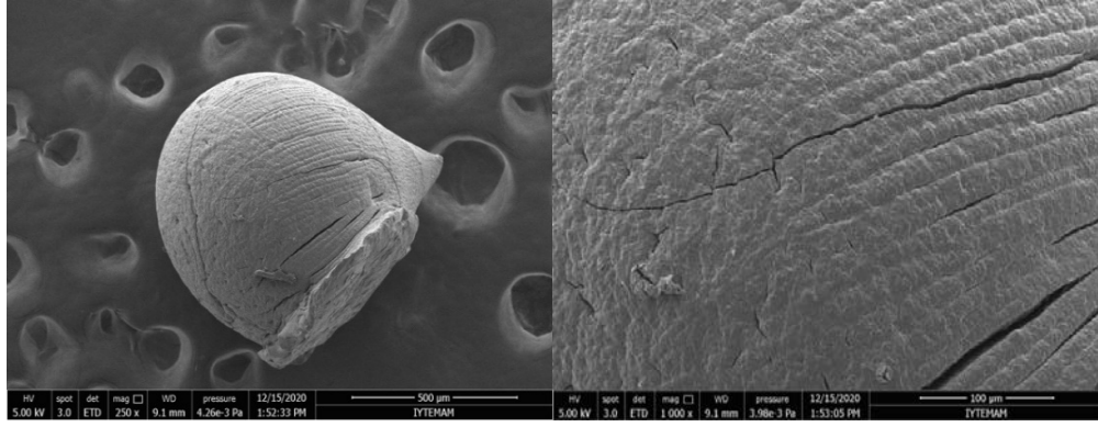
Resim 17. HRP ve lipaz ko-immobilize edilmiş manyetik aljinat/kitosan boncukların 250 kat (solda) ve 1000 kat (sağda) büyütülmüş SEM fotoğrafları (Ko-immobilize manyetik aljinat/kitosan boncuk: %5 CaCl 2 , %2 aljinat, %1 kitosan, 10 mg Fe 3 O 4 ; HRP: 0,4 mg/mL; lipaz: 4 mg/mL).
