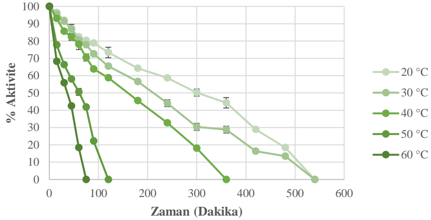
Şekil 87. Aljinat boncuklarda HRP ile ko-immobilize edilmiş lipaz enziminin farklı sıcaklıklardaki ısıl kararlılık grafiği (Lipaz: 4,0 mg/mL; pNPL: 10 mM; pH: 7.0).
